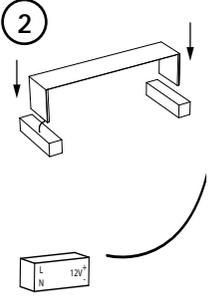
**appoggiare la panca sul basamento e collegare l'alimentatore remoto rispettando l'uscita 12V, polarità +/- ed ingresso di rete 230V**
