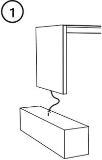
**Creare un manufatto in cemento come basamento con punto luce centrale e collegare il punto luce a terra in bassa tensione con il cavo della seduta rispettando la polarità +/-**
