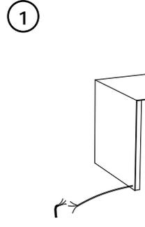
**collegare il punto luce a terra in bassa tensione con il cavo della seduta rispettando la polarità +/-**
