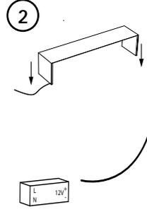
**appoggiare la panca a terra in posizione desiderata e collegare l'alimentatore remoto rispettando l'uscita 12V, polarità +/- ed ingresso di rete 230V**
