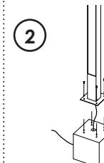
**fissare il corpo lampada al basamento tramite fissaggi predisposti**
