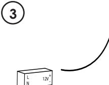
**collegare il driver remoto con alimentazione 230V, ingresso LED rispettando polarità +/-**
