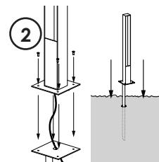
**fissare il corpo lampada al picchetto tramite viti e inserire questo al terreno**
