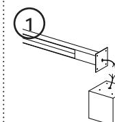
**Creare un manufatto in cemento come basamento con punto luce centrale e collegare il cavo in uscita dal paletto con punto luce a terra rispettando la polarità (+/-) realizzando giunzione stagna**
