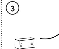
**collegare il driver remoto con alimentazione 230V, ingresso LED rispettando polarità +/-**
